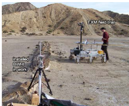
1. ábra. A BHWI furatlyuk-fal képfelvevő a rover terepi példányá mellett a Tabernas-sivatagban.
